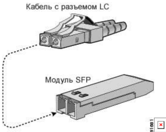
Рисунок 18: Подключение кабеля с разъемом типа LC к порту Fibre Channel
