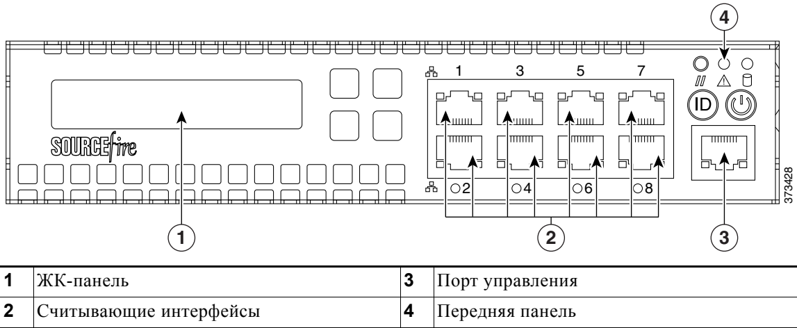
Рисунок 1-9 8-портовые медные интерфейсы 1000BASE-T с настраиваемым обходом
