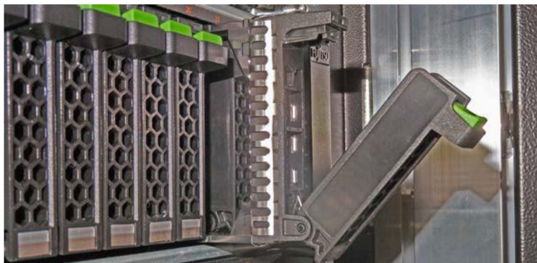
Рисунок 17: Снятие/установка жесткого диска 2,5 дюйма
