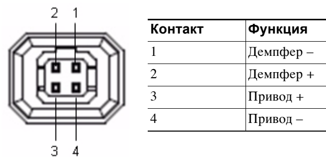
Рис. 1-4 Назначение контактов разъема объектива P-iris
