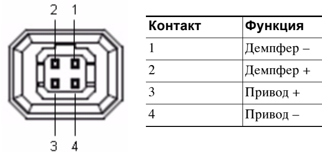
Рис. 1-4 Назначение контактов разъема объектива P-iris
